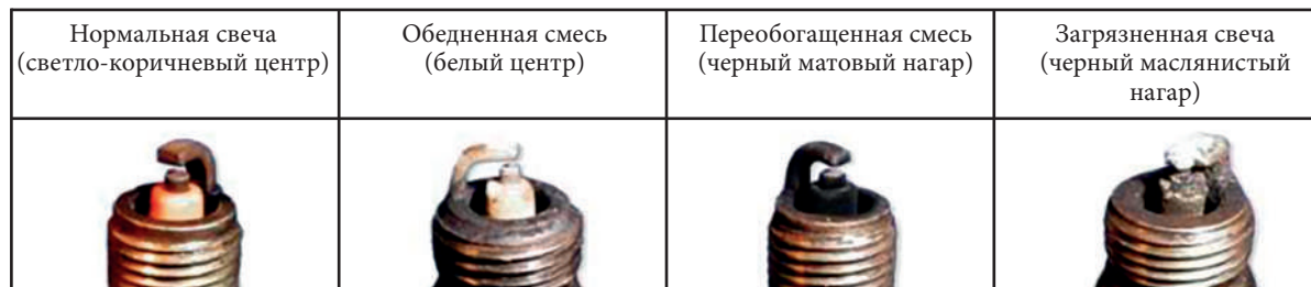
Фото 5.15. Состояния свечей зажигания
