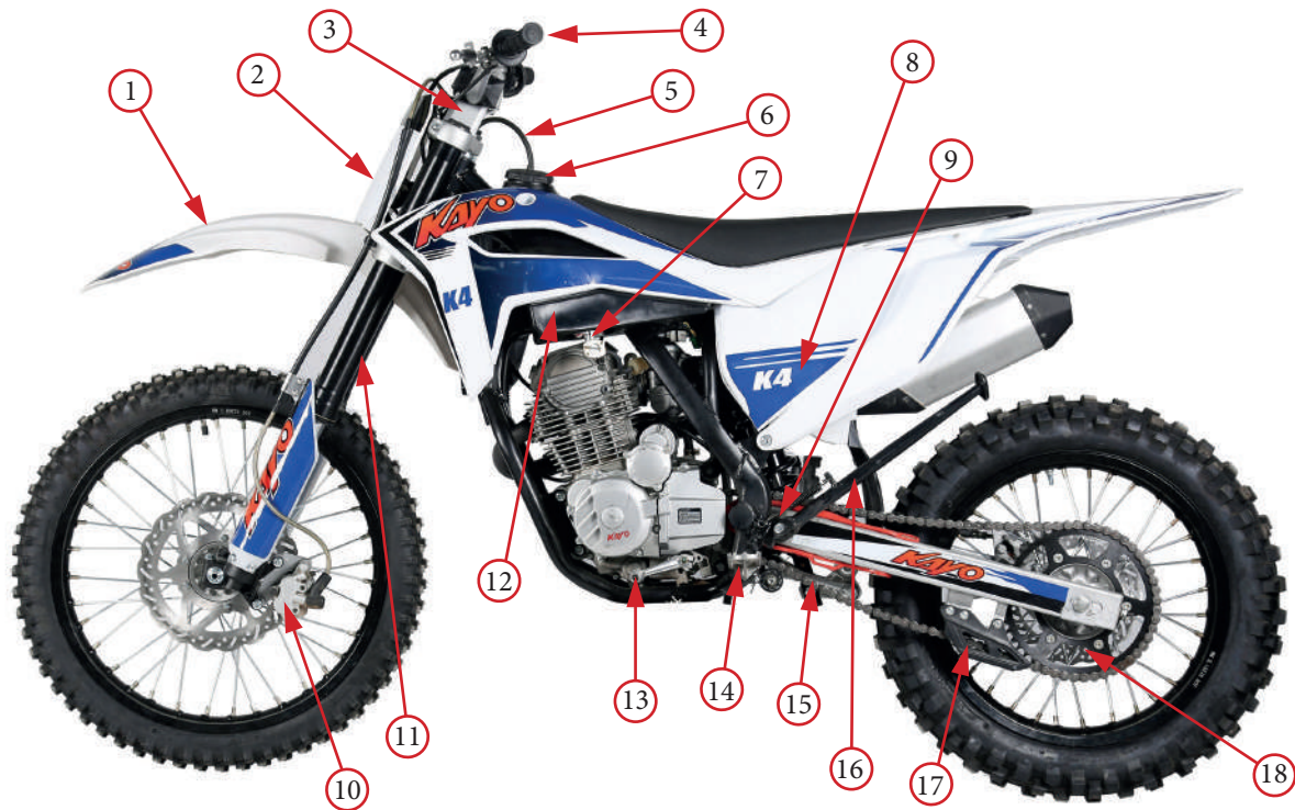
Фото 2.1. Левая сторона мотоцикла: 1 – переднее крыло; 2 – передний щиток; 3 – верхняя траверса; 4 – руль; 5 – вентиляционная трубка; 6 – крышка бака; 7 – топливный кран; 8 – крышка доступа к воздушному фильтру; 9 – крышка направляющей цепи; 10 – передний тормозной суппорт; 11 – передняя вилка; 12 – топливный бак; 13 – рычаг переключения передач; 14 – левая подножка водителя; 15 – цепь; 16 – боковая подставка; 17 – направляющая цепи; 18 – задняя звездочка
