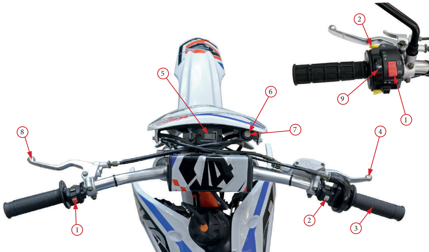
Фото 2.3. Приборы и органы управления: 1 – кнопка выключения двигателя; 2 – кнопка стартера; 3 – рукоятка акселератора; 4 – рычаг переднего тормоза; 5 – счетчик моточасов (приборная панель); 6 – замок зажигания; 7 – рычаг сцепления; 8 – рычаг переднего тормоза; 9 – переключатель фары (ближний/дальний свет)
