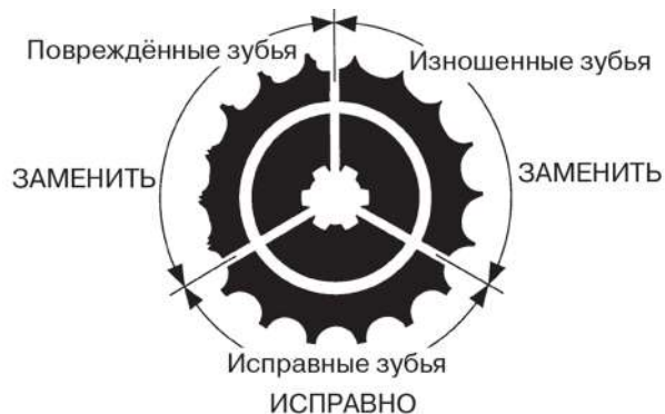
Рисунок 5.27. Вид зубьев звездочки
