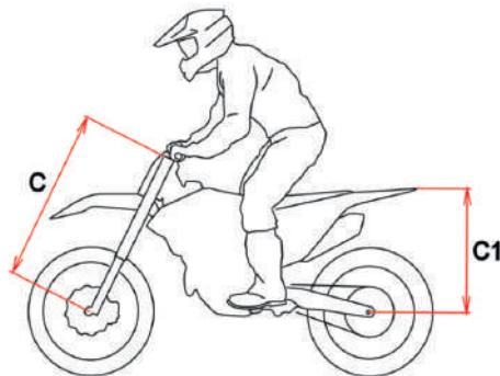
Рисунок 5.35. Замеры в нагрузке.
