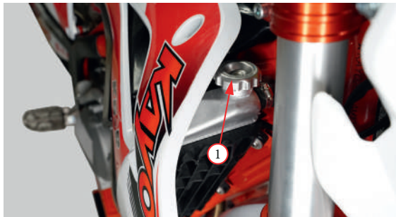
Фото 5.6. Контроль уровня охлаждающей жидкости.
