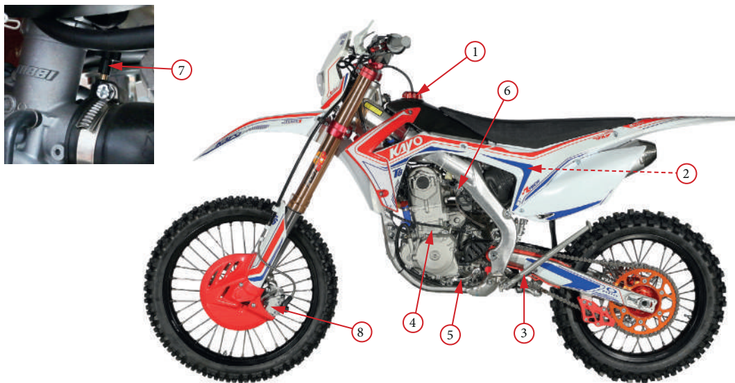
Фото 2.1. Левая сторона мотоцикла: 1 – крышка заливной горловины; 2 – воздушный фильтр; 3 – боковая подножка; 4 – номер двигателя; 5 – рычаг переключения передач; 6 – топливный кран; 7 – рычаг обогатителя топливной смеси (подсос); 8 – передний тормозной суппорт.
