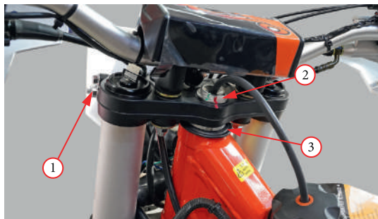
Фото 5.33. Регулировка подшипников рулевой колонки.
