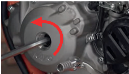
Фото 5.37. Направление вращения коленчатого вала.
