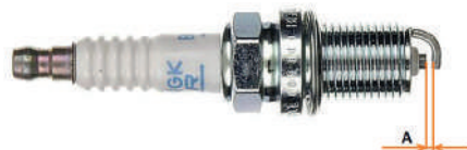
Фото 5.16. Зазор между электродами свечи зажигания.
