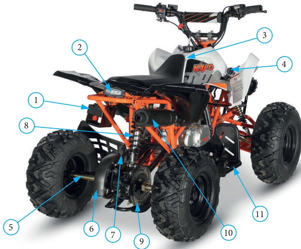
Фото 2.3. Вид с тыльной стороны комплекта запчастей: 1 - аккумуляторная батарея; 2 - задний фонарь; 3 - топливный бак; 4 - замок зажигания; 5 - ось задних колес; 6 - защита ведомой звезды; 7 - приводная цепь; 8 - задний амортизатор; 9 - задний тормозной диск; 10 - глушитель; 11 - правая подножка водителя
