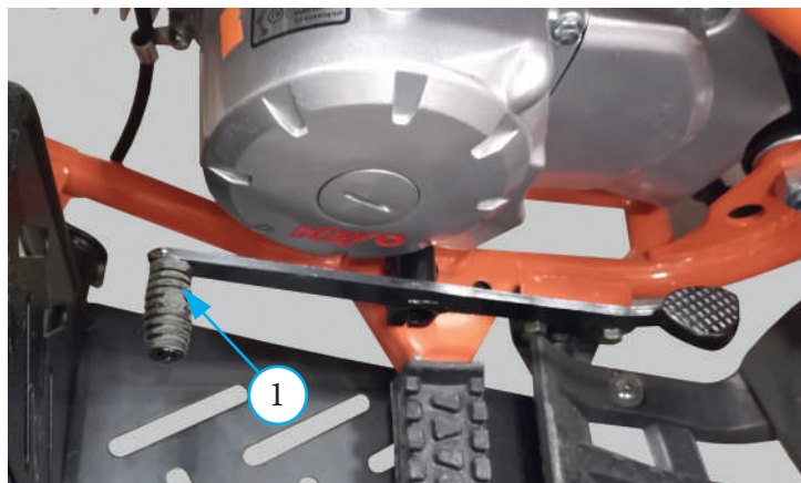
Фото 3.6. Рычаг переключения передач (ножной и ручной)
