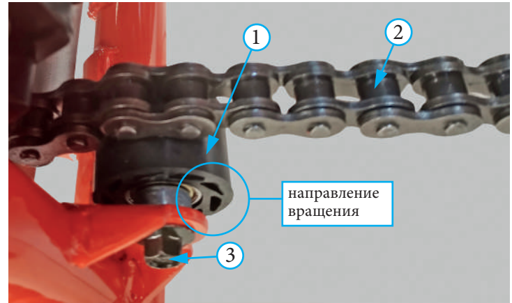
Фото 5.15. Ролик натяжителя цепи: 1 - ролик; 2 – цепь; 3 – винт крепления ролика
