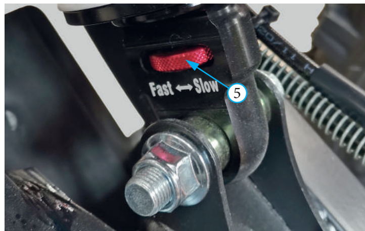
Фото 5.22. Гайка регулировки отбоя заднего амортизатора
