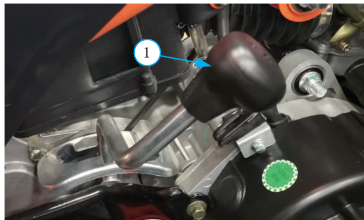
Фото 3.6. Рычаг переключения передач (ножной и ручной)
