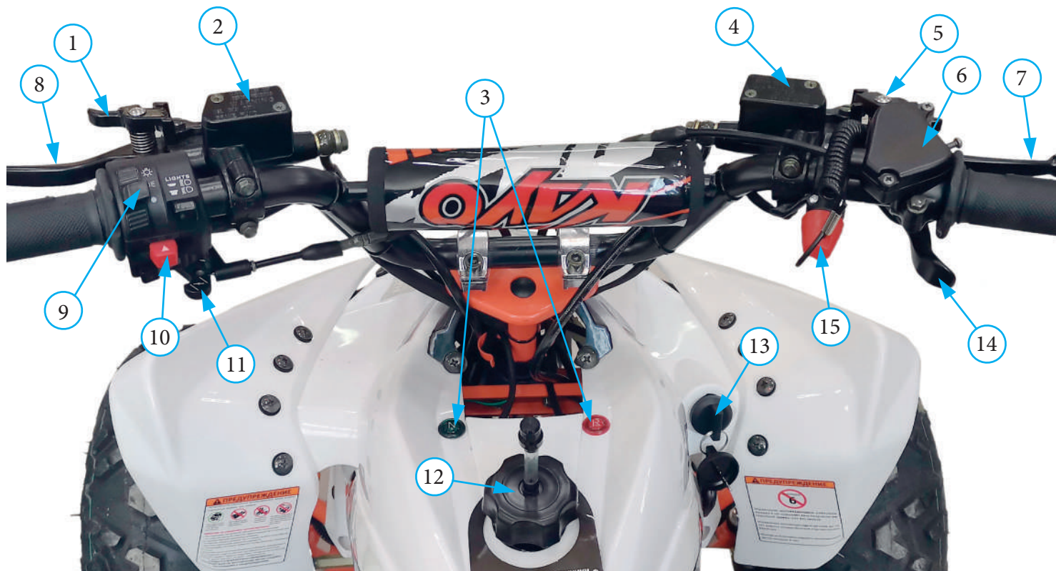
Фото 2.2. Приборы и органы управления комплекта запчастей: 1 - фиксатор стояночного заднего тормоза; 2 - бачок заднего тормоза; 3 - индикаторы (либо приборная панель); 4 - бачок переднего тормоза; 5 - фиксатор стояночного переднего тормоза; 6 - узел акселератора; 7 - рычаг переднего тормоза; 8 - рычаг заднего тормоза (либо рычаг сцепления для некоторых моделей); 9 - клавиша включения/выключения света; 10 - кнопка электростартера (вкл./выкл. двигателя); 11 - рычаг обогащения смеси (для модели TOR на карбюраторе); 12 - крышка топливного бака с сапуном; 13 - замок зажигания; 14 - рычаг акселератора; 15 - чека аварийного выключения двигателя (для MINI BULL)
