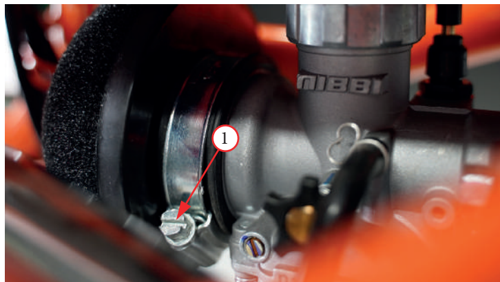
Фото 5.6. Крепление воздушного фильтра
