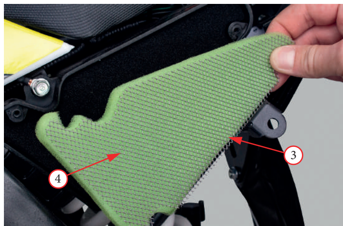
Фото 5.7. Обслуживание воздушного фильтра закрытого типа
