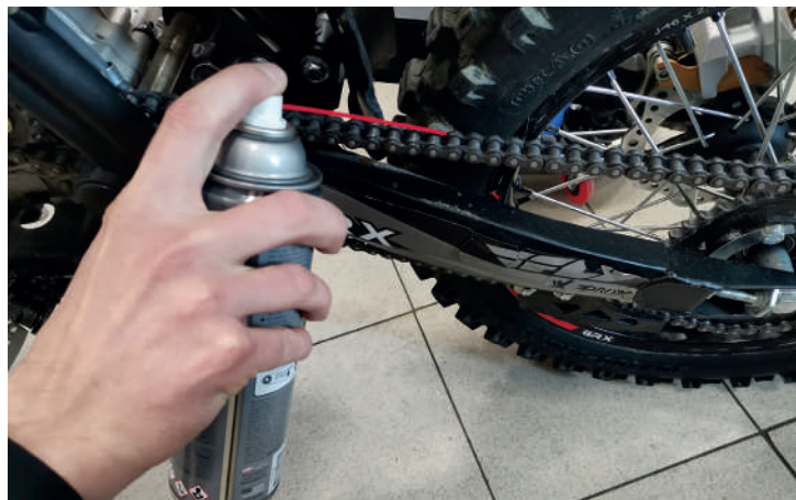
Фото 5.27. Очистка и смазка цепи
