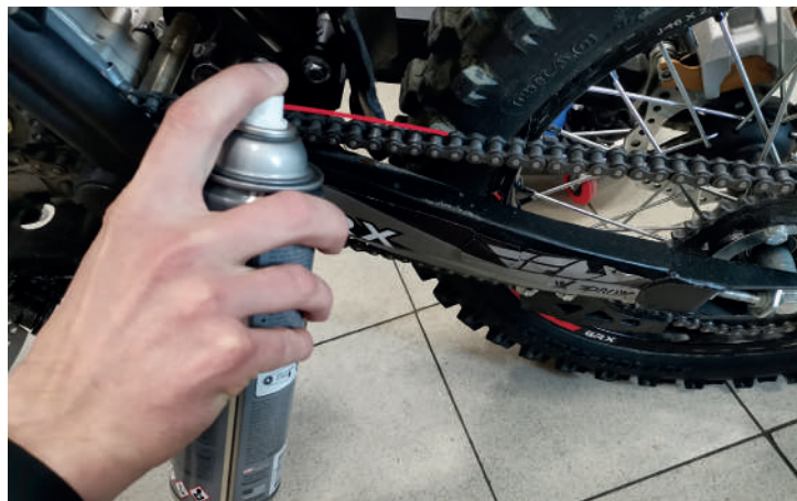
Фото 5.27. Очистка и смазка цепи
