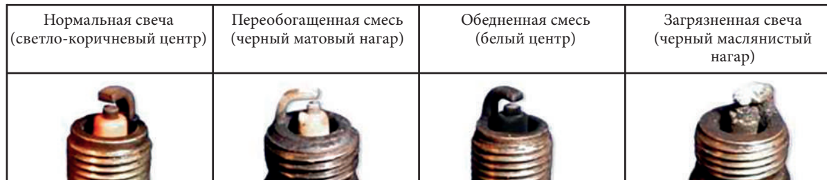
Фото 5.13. Состояния свечи зажигания
